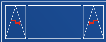
3-teiliges Element mit 2 Schiebeflügeln und Festverglasung
